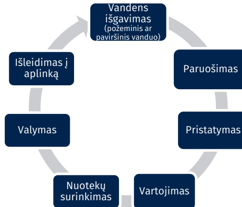
1 pav. Pagrindiniai geriamojo vandens tiekimo ir nuotekų tvarkymo etapai
